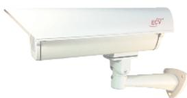
Carcasa para exteriores de aluminio, protección IP66. Ventana cuadrada 72x72mm. Dimensiones exteriores: 140x112x400mm. Dispone de calefactor y ventilador, pasacables por el soporte. Alimentación 220VAC.
