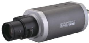
1/3" CCD Sony *Effio-E*, 700 TVL, 0,08 lux/F1.2. D/N Filtro IR-cut. DWDR/AGC/BLC/2D-DNR. Máscaras de privacidad 4 zonas, detección de movimiento, títulos de cámara, efecto espejo. Alimentación: AC110-240V.
