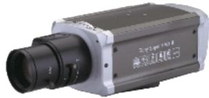
1/3" CCD Sony *Effio-P*, 700 TVL, 0,1 lux/F1.0. D/N Filtro IR-cut. WDR/AGC/BLC/3D-DNR. Máscaras de privacidad 8 zonas, detección de movimiento, títulos de cámara, efecto espejo. Detección de rostro, Flip, E-zoom. Relé de alarma. Alimentación: AC110-240V.
