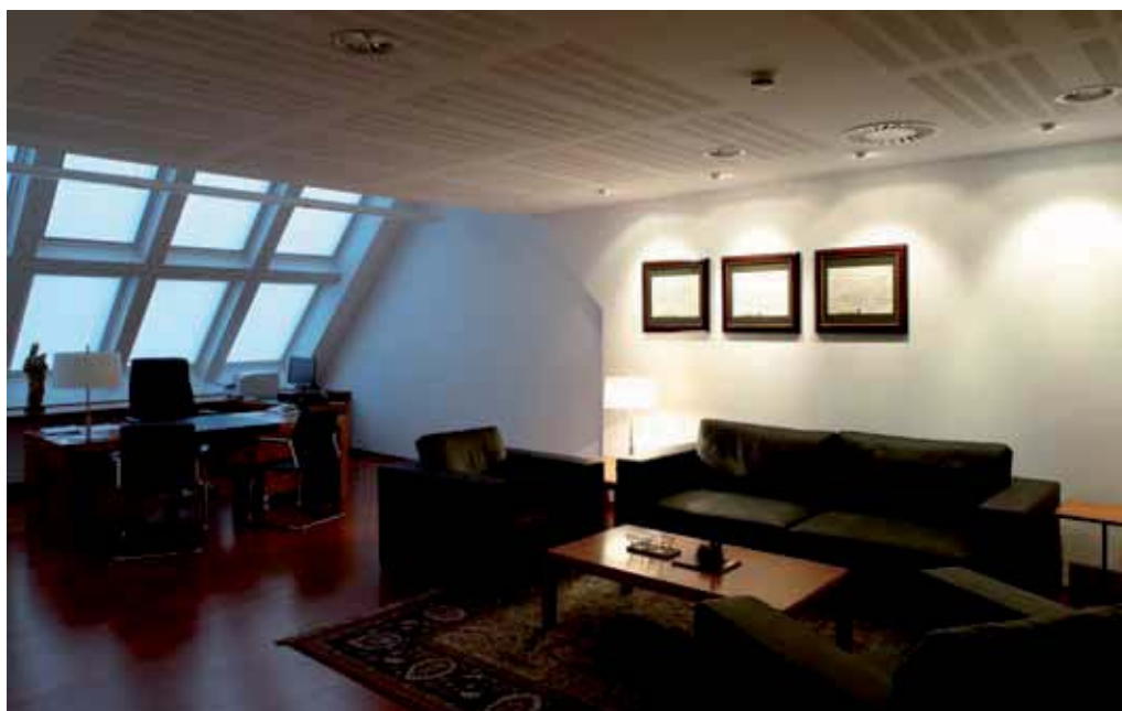
Escena lectura (Luminarias ambiente encendidas al 100%, luminarias escritorio y de iluminación general apagadas) Reading scene (Ambient luminaries switched on 100%, writing-desk luminaries and general illumination are switched off) Scène Lecture (Luminaires d'ambiance allumés à 100%, luminaires bureau et éclairage général éteints)
