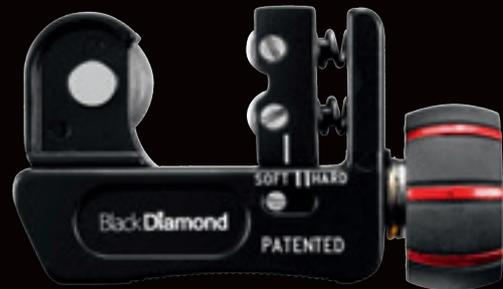
Mini cortatubos de la serie Black diamond de dimensiones 78x42x28mm, puede cortar diámetros de tubería desde 1/8" a 7/8" (4-22 mm). Incluye el innovador y patentado sistema de resorte que permite alargar la vida de los cortatubos y de la lama; se adapta además a superficies que no son perfectamente redondas.
