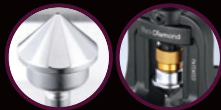
Herramienta patentada que se puede usar para abocardar o para ensanchar el tubo. El cono del abocardador escarifica y alisa la tubería durante la operación, creando un acabado superficial excepcional cuando el abocardado está completo. El racor de acoplamiento adaptador permite al usuario de quitar rápidamente el cono abocardado y las cabezas del ensanchador.
