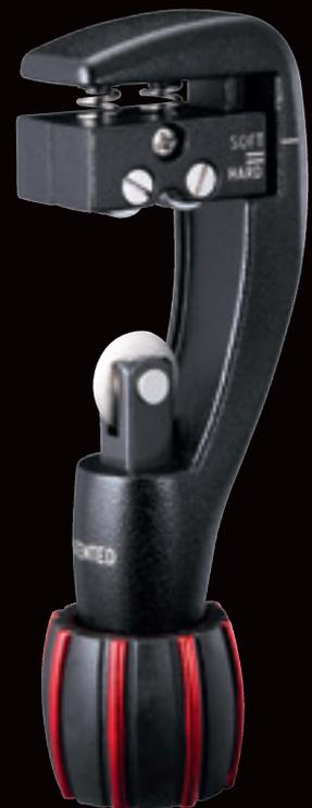
Cortatubos doble resorte que corta diámetros de tubería desde 1/8" a 1-1/4" (4-32 mm). El sistema de doble resorte permite cortar tubería de cobre, aluminio y acero inoxidable hasta 2 mm de espesor.
