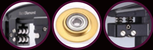
Cortatubos de alta resistencia de la serie Black diamond con 6 rodillos de rodamientos y lama con acabado en titanio para los cortes más difíciles. Corta diámetros de tubería desde 1/4" a 1-1/4" [4-32 mm). El sistema de doble resorte permite cortar tubería de cobre, aluminio y acero inoxidable hasta 3 mm de espesor.
